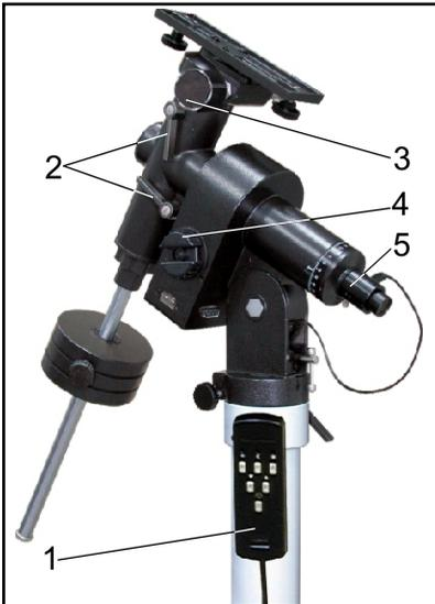
□ Управление приводом проводится с помощью пульта-корректора (1), предусматривающего три линейные скорости слежения: звездную, солнечную и лунную, а также две скорости коррекции - увеличивающую и замедляющую скорости движения на 50%. Пульт оснащен устройством местного освещения.
