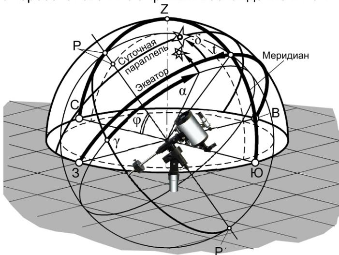
**Рисунок 1- Подвижная и неподвижная экваториальные системы координат.**
