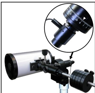
Полярная ось и ось склонений имеют координатные круги, помогающие в поисках небесных объектов по звездным координатам - прямому восхождению и склонению. Установка координатных кругов проводится после точной установки полярной оси монтировки на полюс Мира.
