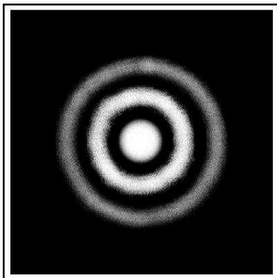
более двух круглых колец. Разрывы и нарушения формы ядра или дифракционных колец не допускаются.
