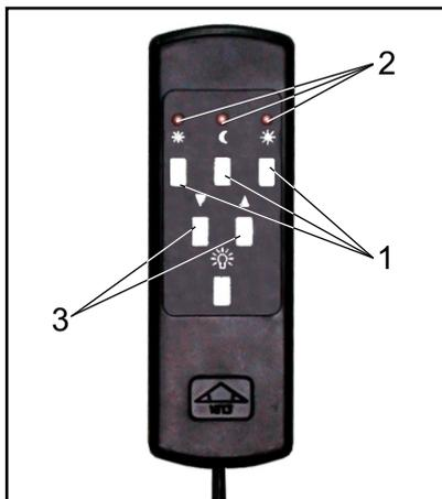
□ Запустите часовой привод нажатием одной из кнопок пульта выбранной скорости (1), при этом должен загореться соответствующий светодиод (2). Повторным нажатием той же кнопки привод отключается.
